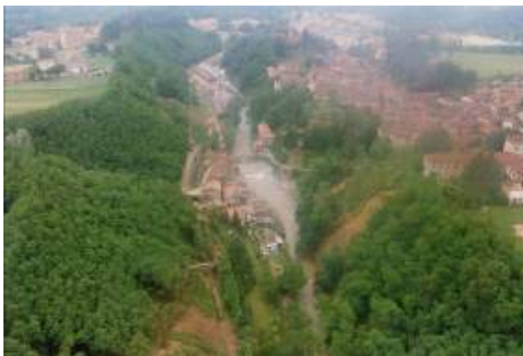
Figura 30 – Frane superficiali su entrambe le scarpate dei terrazzi fluviali in località Mulini, con interruzione della viabilità provinciale lungo la VASP42 all'altezza dei tornanti del "Piccolo Stelvio". Fonte: Archivio CNR IRPI Torino.
