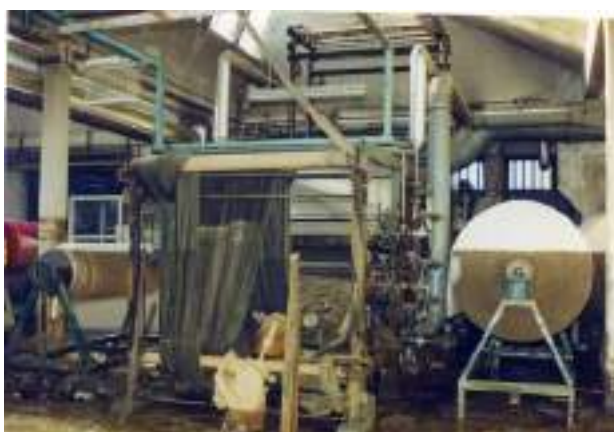
Figura 27 – L’esondazione del Fiume Olona interessa lo stabilimento Gaspare Tronconi Spa a Fagnano Olona dove l’acqua raggiunge quasi i due metri di altezza, come mostrano i segni lasciati dal fango sui macchinari e le bobine di tessuti. Fonte: Archivio d’impresa [53].
