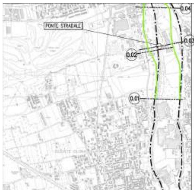
Figura 51 - Sezioni fluviali considerate nella simulazione idraulica di rischio idraulico a valle conseguente errate manovre sugli scarichi di fondo della Diga di Olona. La curva verde continua rappresenta la delimitazione delle aree di allagamento conseguenti tali manovre; la curva tratteggiata nera rappresenta il limite della Fascia C relativa al PAI. Fonte: [4]
